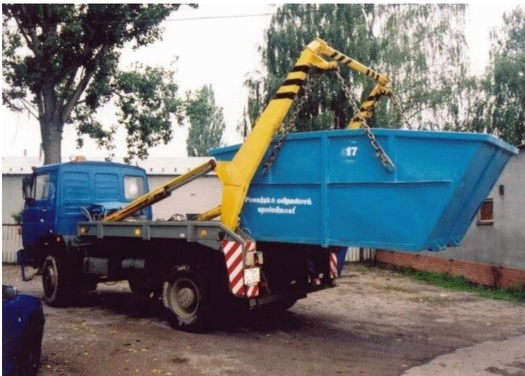
Vozidlo na prepravu veľkoobjemových kontajnerov (5-10 m 3 ) s ramenovým nakladačom.
